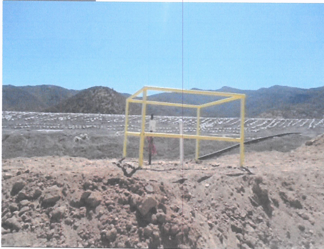
Imagen 2. Fotografía de lisímetro ubicado en pila.
